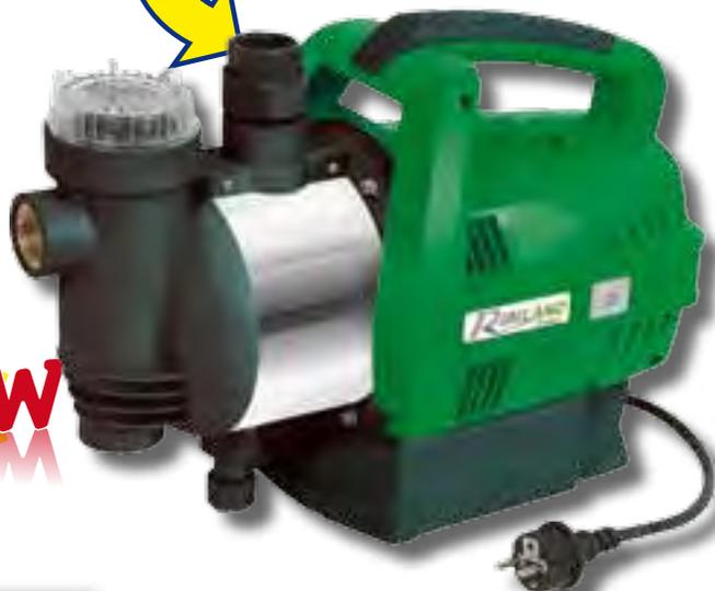
Pompe à eau de surface carénée, avec contrôleur automatique intégré, assurant la fonction marche/arrêt de la pompe et la coupure automatique en cas de manque d'eau. Classe IP X4. Corps moteur en fonte d'aluminium. Corps de pompe en inox. Arbre moteur en acier 420. Carénage en polypropylène renforcé fibre de verre. Équipée d'un système de filtration. Mise en route par interrupteur.
