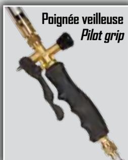
Désherbeurs thermiques professionnels sur bouteille de gaz. Poignée veilleuse 100% métal, gainée plastique pour plus de confort, avec gachette de réglage du débit. Lance, brûleurs et crochet de maintien en acier chromé. Utilisation sur butane en prise directe sans détendeur ou sur propane avec détendeur (option). Température max. 1 800°C. Catégorie d'appareil : 3.
