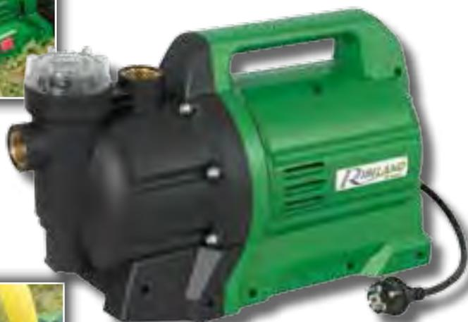
Pompe à eau de surface auto-amorçante, entièrement carénée. Corps moteur et pompe en fonte d'aluminium. Arbre moteur en acier carbone type 45. Carénage en polyamide renforcé fibre de verre. Équipée d'un système de filtration. Mise en route par interrupteur. **Puissance 1.300 W.** 2.850 tr/min. Pression max : 4,8 bars. Hauteur d'aspiration max. 7 m. Câble électrique 1 m.
