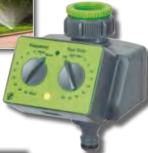
**Programmeur manuel** avec nez de robinet 20x27 (3/4") et réduction 15x21 (1/2") équipé d'un filtre métal. Fonctionne avec une pile 9 V. Voyant de perte de charge de la batterie avec verrouillage automatique. Fréquence d'arrosage sur 72 heures (par fraction de 1 heure) et sur 7 jours. Durée d'arrosage réglable de 1 à 120 minutes. Fonction temporisation pour décaler l'heure de programmation : maxi 12 h. Pression de service : mini 0,5 bar, maxi 8 bars. Température maxi : 60°C.
