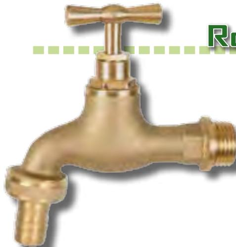
**Robinet de jardin** à clapet en laiton. Entrée 15 x 21 (1/2") Nez 20 x 27 (3/4") avec raccord cannelé pour tuyau Ø 15.
