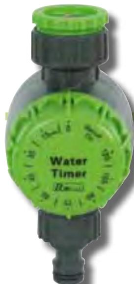
**Minuteur d'arrosage** avec nez de robinet 20x27 (3/4") et réduction 15x21 (1/2"). Système manuel (mise en route avec molette). Durée d'arrosage réglable de 1 à 120 minutes.
