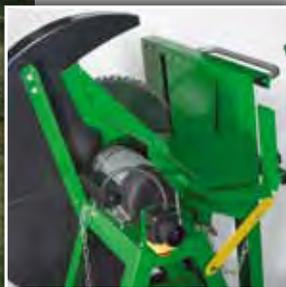
**Scie à bûches** monté sur châssis en acier laqué et support de bûches en tôle laquée. Moteur monophasé 230V - 50Hz. 3 000 W. Lame en carbure de tungstène 36 dents Ø 600 mm x 30 mm, sous carter de protection en tôle. Ø de coupe : 30 à 210 mm. Butée de coupe extensible jusqu'à 500 mm. Hauteur de travail : 975 mm. Dimensions : 970 x 760 x 1260 mm. Poids : ± 100 kg
