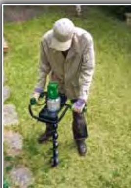
**Tarière électrique.** Conçue pour forer la terre, implanter les poteaux d'une clôture, planter des arbustes... Moteur 230 V-50 Hz. Puissance 1 200 W. Double poignée ergonomique avec interrupteur marche/arrêt. Livrée avec une mèche en acier laqué (Ø 15 cm x 56 cm utile).
