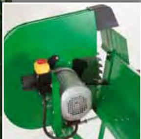
**Scie à bûches** montée sur châssis en tubes acier carrés 30 mm laqué, et support de bûches en tôle laquée. Moteur monophasé 230V ~ 50Hz. 1 800 W. Lame en carbure de tungstène 40 dents Ø 450 x 30 mm, sous carter de protection en tôle. Ø de coupe : 20 à 160 mm. Butée de coupe extensible jusqu'à 640 mm. Hauteur de travail : 770 mm. Dimensions : 1 040 x 845 x 300/140 mm. Poids : ± 36 kg.
